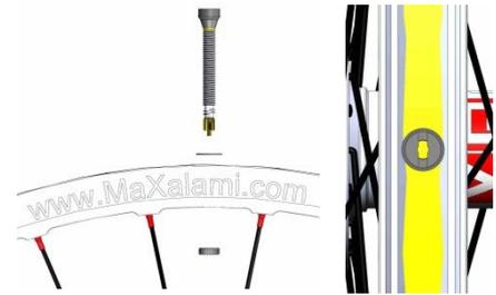
1. Montieren Sie den Reifen bei Raumtemperatur einseitig auf die Felge. Positionieren Sie die PTN mit dem gelben PTN Aufkleber gegenüber dem Ventil. Die PTN sollte mit leichter Spannung auf der Felge sitzen.
