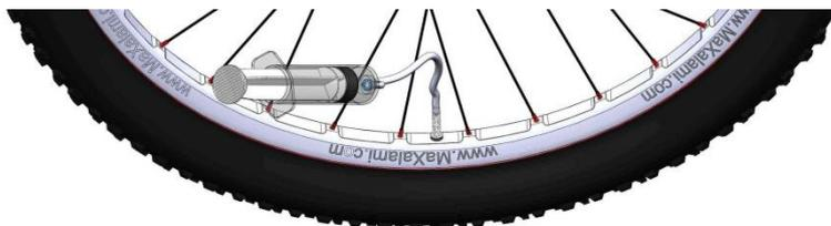
3. Drücken Sie die restliche Reifenflanke über die Felge und pumpen den Reifen auf ca. 2 bar auf, so dass der Reifen sich in das Felgenhorn setzt. Bei Verwendung von Reifenhebern, kann die PTN beschädigt werden.
